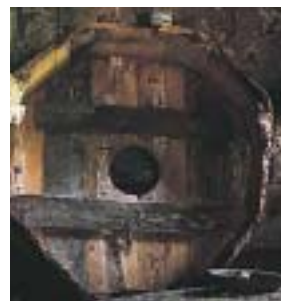
Hegazpea edo ehotarriak babesten dituen egurrezko estalkia: hautsa harrotu eta irina ateratzea saihesten du, eta gauzaki arrotzak sartzeko galarazten. Ezkerraldean, bereizita dagoela ikusten da, eta eskuineko aldean, egoera zuzenean, iraun duten ehotarri-pare bakarraren gainean.
